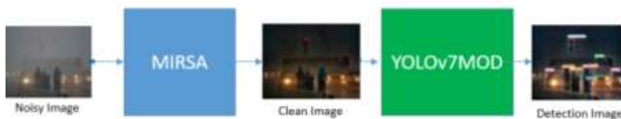
Gambar 6 Arsitektur Model Deteksi dan Denosing MIRSA+YOLOV7MOD
