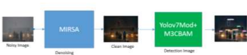
Gambar 7 Arsitektur Model Deteksi dan Denoising MIRSA+YOLO7MOD+M3CBAM
