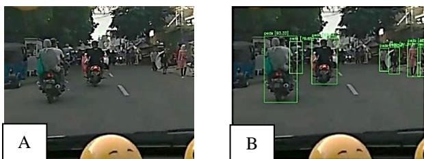
Gambar. 7. Perbandingan Hasil Deteksi pada Bagian Cropping Model A dan Model B
