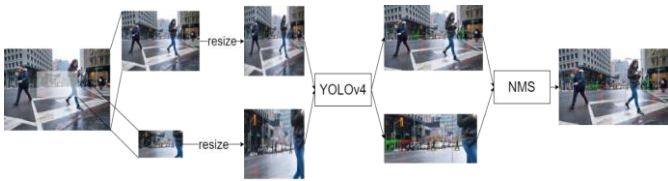
Gambar. 3. Proses Pendeteksian Ganda dengan YOLO
