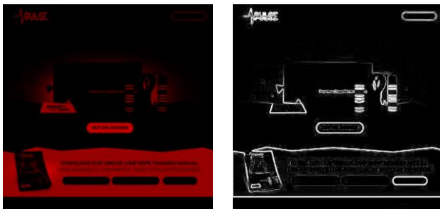
Gambar IV-5. Perbandingan Hasil Selisih Tanpa Deteksi Tepi (Kiri) dan Menggunakan Deteksi Tepi (Kanan)
