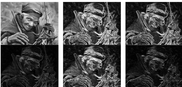
Gambar II-2. Hasil Deteksi Tepi Berbagai Operator Citra awal (kiri atas); Sobel (tengah atas); Prewitt (kanan atas); Robert (kiri bawah); Laplacian (tengah bawah); LoG (kanan bawah)
