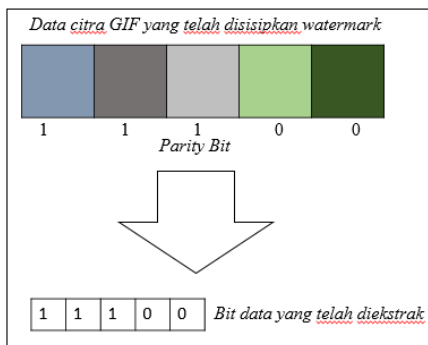
Gambar 9. Ekstraksi Bit Data Menggunakan Parity Bit.
