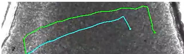
Gambar 5 Pergerakan microbots yang diatur oleh medan magnet
