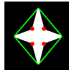
Gambar 9. Convexity Defects yang Ditandai dengan Titik Merah
