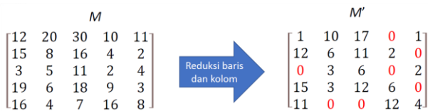
Gambar 4. Reduksi matriks M menjadi matriks tereduksi M' (Sumber: Diktat Kuliah Strategi Algoritma ITB )
