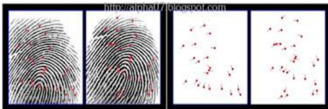
Gambar 3. Titik-titik *minutiae* (Sumber: <http://alpha07.blogspot.co.id/2012/03/cara-kerja-fingerprint-scanner.html> 8 Mei 2016)
