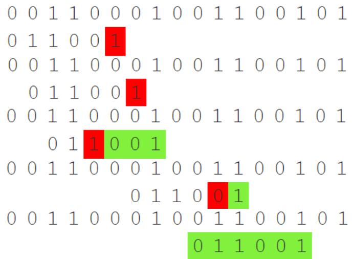
Gambar 9 - mekanisme pencocokan dengan algoritma BM
