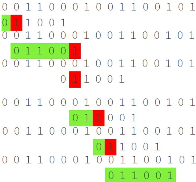
Gambar 4 - mekanisme pencocokan dengan algoritma KMP
