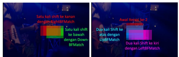
Gambar 4.2: Urutan pencocokkan gambar dari tengah secara spiral untuk satu iterasi, ukuran pola dan pergeseran diperbesar
