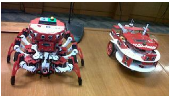
Gambar 2. Contoh bentuk robot divisi Berkaki (kiri) dan robot divisi Beroda (kanan) (sumber : Panduan KRPAI 2013 Dikti)
