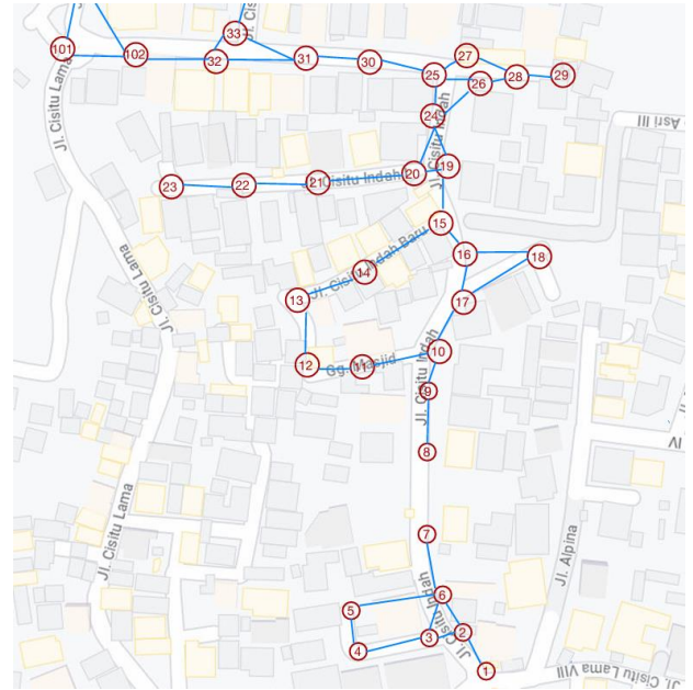
Gambar 12. Cut-Set pada Kasus Nyata Kabel Udara Terbakar (Sumber : Arsip Pribadi)
