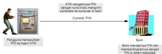
**Gambar 2.8** Mekanisme enkripsi dan dekripsi PIN pada transaksi dengan mesin ATM, diambil dari [8]
