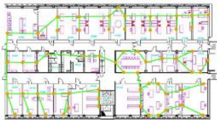
Gambar 8. Jaringan listrik pada satu lantai perkantoran Sumber gambar dasar : researchgate.net
