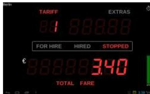
Gambar 3.2 Argometer saat taksi mengangkut penumpang, namun dalam keadaan berhenti
