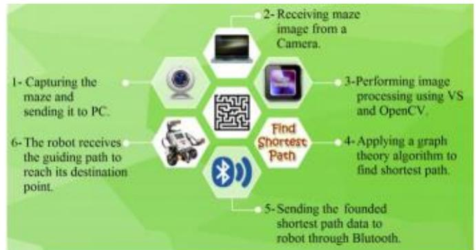
Gambar 3.1 Tujuan dari Sistem Robot Pemecah Labirin
