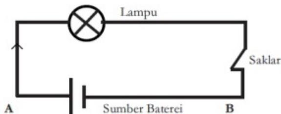
Gambar 1.1 Rangkaian Lampu Sederhana dengan Saklar<sup>[5]</sup>
