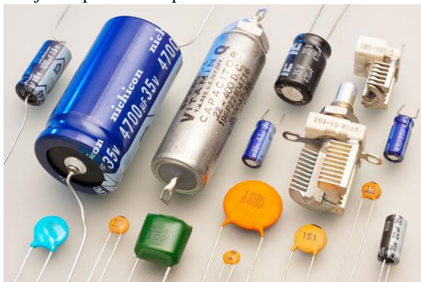
Gambar 4.3 Kapasitor dalam berbagai bentuk dan ukuran
