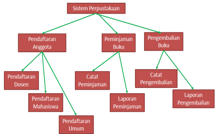
Gambar 4.1 Dekomposisi untuk Sistem Perpustakaan Sumber : Slide Kuliah IF1208_08_DekomposisiMasalahdanNotasiAlgoritmik.pdf
