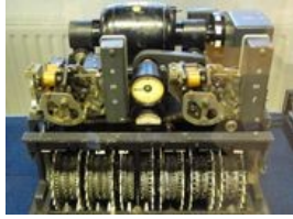
gambar 3 : mesin pembaca chipertext Lorenz milik Jerman, digunakan saat PD II
