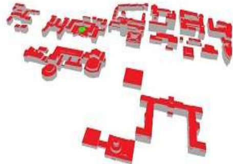
Gambar 8 : model 3 dimensi dari bagian jantung kota Stuttgart, mengandung 111 stuktur dengan total 5.959 simpul dan 11.474 segitiga. Ukuran dalam format VRML : 435,6 kb
