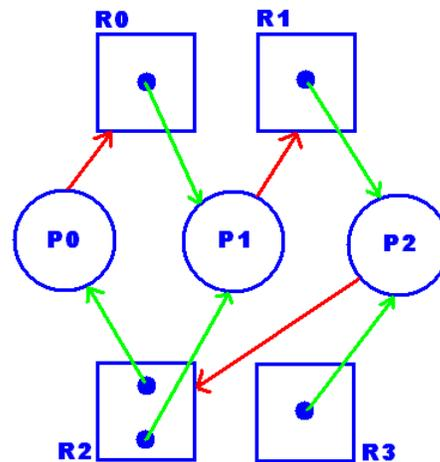
Pada gambar di atas ditemukan *cycle* yang berpotensi menimbulkan *deadlock*, *cycle* yang pertama  $R_2 \rightarrow P_0 \rightarrow R_0 \rightarrow P_1 \rightarrow R_1 \rightarrow P_2 \rightarrow R_2$  dan *cycle* kedua  $R_2 \rightarrow P_1 \rightarrow R_1 \rightarrow P_2 \rightarrow R_2$ . Pada graf alokasi sumber daya di atas semua sumber daya memiliki satu instans kecuali sumber daya  $R_2$ . dari graf dapat ditarik beberapa hal tentang system :
