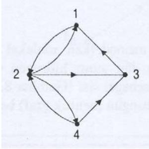
Pada graf jenis ini, sisi yang menghubungkan simpul 3 ke simpul 1 tidak sama dengan sisi yang menghubungkan simpul 1 ke simpul 3 karena orientasi arahnya berbeda.
