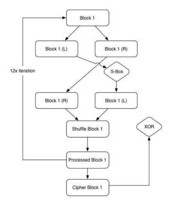
Plaintext masukan dari pengguna terlebih dahulu dibagi kedalam beberapa blok, dimana satu blok berukuran 64 bit. Kemudian blok tadi masuk ke Feistel Network, dibagi menjadi 2 blok berukuran sama besar, blok kiri (L) dan blok kanan (R). Fungsi yang digunakan dalam Feistel Network ini adalah dengan memanfaatkan S-Box.
