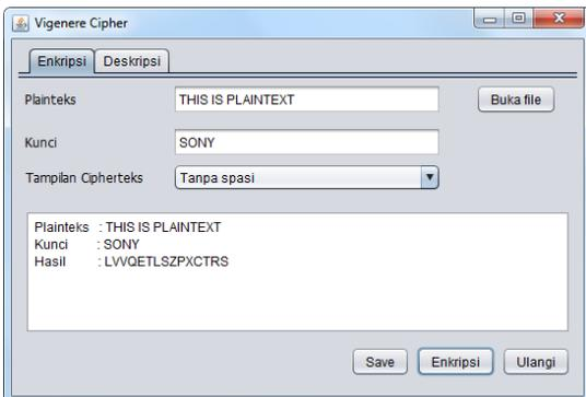
Gambar 3.2 Contoh proses enkripsi dengan format cipherteks tanpa spasi
