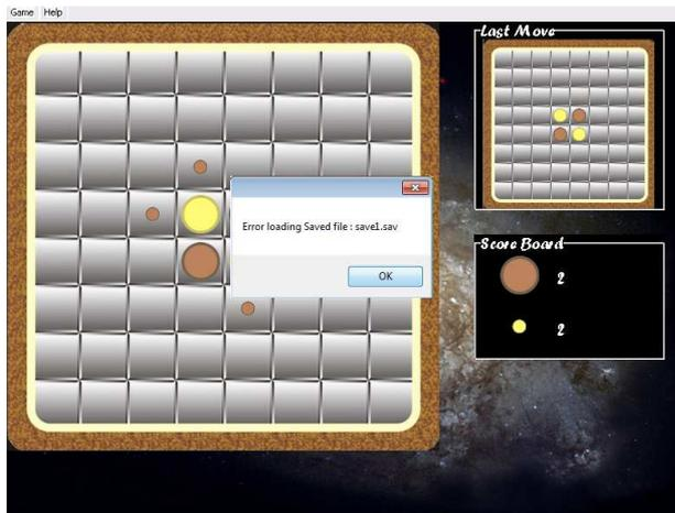
Sistem pengecekan error ini mirip dengan digital signature di mana file save data akan dimasukkan ke fungsi hash kemudian dicocokkan dengan nilai hash yang ada pada saved data itu sendiri.
