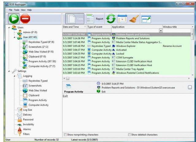
**Keylogger** merupakan sebuah perangkat baik perangkat keras atau perangkat lunak yang digunakan untuk memantau penekanan tombol keyboard. Sebuah *keylogger* biasanya akan menyimpan hasil pemantauan penekanan tombol *keyboard* tersebut ke dalam sebuah berkas log/catatan/rekaman. Beberapa *keylogger* tertentu bahkan dapat mengirimkan hasil rekamannya ke *e-mail* tertentu secara periodik.
