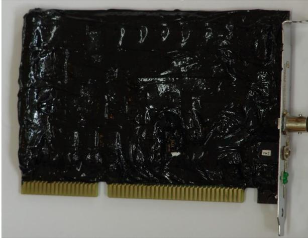
Gambar random generator generasi kedua rw2 adalah kartu ISA, menghasilkan angka 16-bit hardware acak berdasarkan teorema limit sentral.
