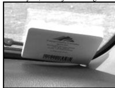
Gambar 7 RFID pada pembayaran tiket masuk tol
