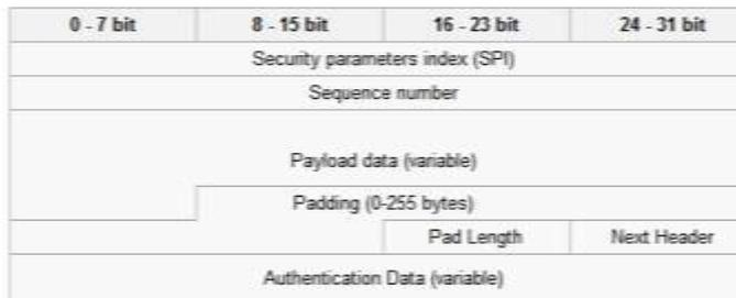
Gambar 1. Ilustrasi ESP
