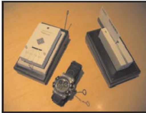
Gambar 3 Perangkat Wireless yang telah diimplementasikan ECC (a) thermostat (b) jam pemonitor kesehatan (c) alat pembaca kartu
