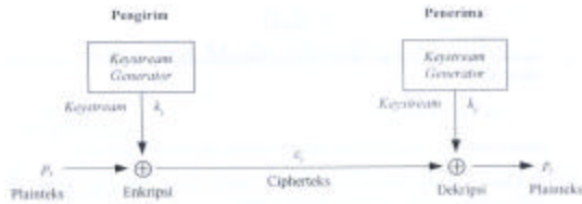
Gambar 3. Skema Enkripsi dan Dekripsi dengan Cipher Aliran
