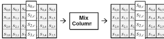
Gambar 18 Ilustrasi Transformasi MixColumn() AES
