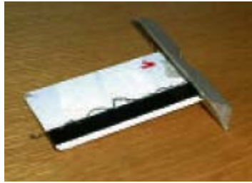
Gambar 11 Alat untuk "menelan" kartu ATM
