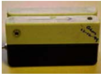
Gambar 14 Skimer , alat "penyaring" data pada kartu ATM
