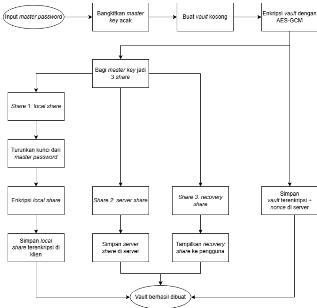
Gambar 2. Diagram Alur Pembuatan Vault
