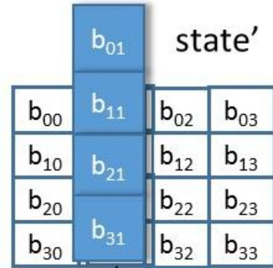
$$\begin{bmatrix} 02 & 03 & 01 & 01 \\ 01 & 02 & 03 & 01 \\ 01 & 01 & 02 & 03 \\ 03 & 01 & 01 & 02 \end{bmatrix} \begin{bmatrix} \\ \\ \\ \end{bmatrix} = \begin{bmatrix} \\ \\ \\ \end{bmatrix}$$
