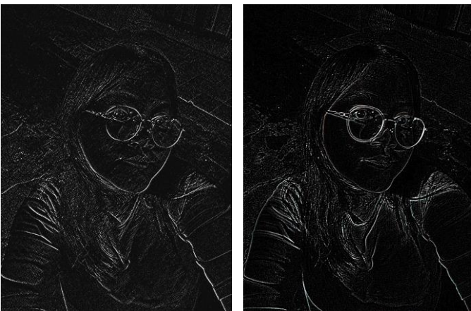
Gambar 3.6 Perbandingan citra hasil rak pendeteksian tepi menggunakan penapis Sobel (kiri) dan Laplacian of Gaussian (kanan), diterapkan dengan penapis Convolution 3x3 (Sumber: dokumen pribadi)
