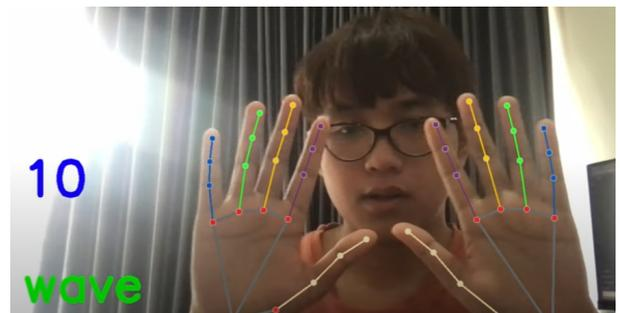
Gambar III.5 Deteksi pose wave dengan dua jari
