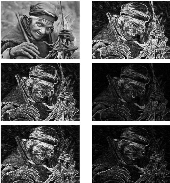
Gambar II.6. Hasil deteksi tepi dengan berbagai operator Citra awal (kiri atas); Sobel (kanan atas); Prewitt (tengah kiri); Robert (tengah kanan); Laplacian (kiri bawah); LoG (kanan bawah)
