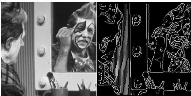
Gambar 2.4 Hasil Deteksi Tepi dengan Operator Canny
