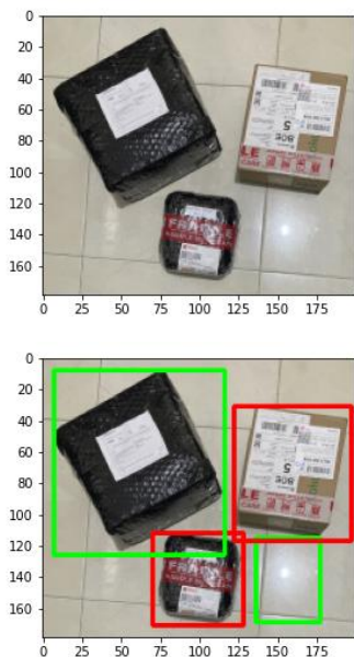
Gambar IV.7 Perbandingan citra masukan (atas) dengan citra hasil deteksi (bawah) pada skenario pencahayaan dan/atau latar yang kurang baik
