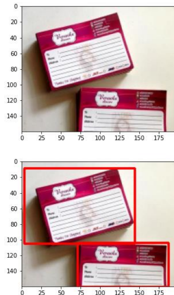
Gambar IV.5 Perbandingan citra masukan (atas) dengan citra hasil deteksi (bawah) pada skenario paket pengiriman berwarna merah
