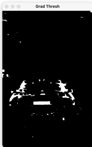
Gambar III.5 Hasil operasi smoothing pada gambar tahap sebelumnya
