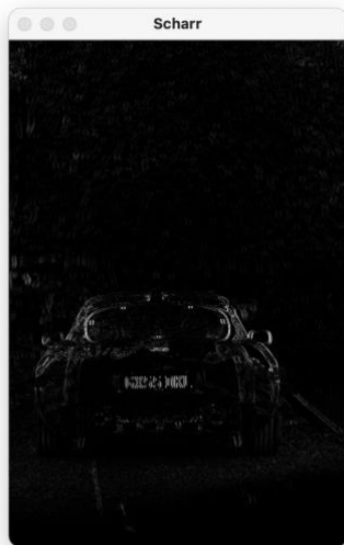
Gambar III.4 Hasil operasi edge detection pada blackhat image
