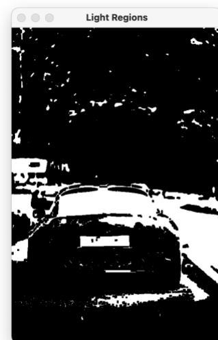
Gambar III.3 Hasil operasi closing pada grayscale image
