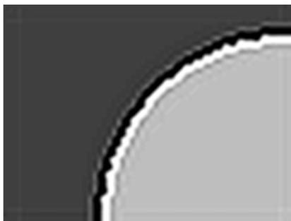
Gambar. 2: Efek gelombang akibat frekuensi pemotong yang tajam [3]
