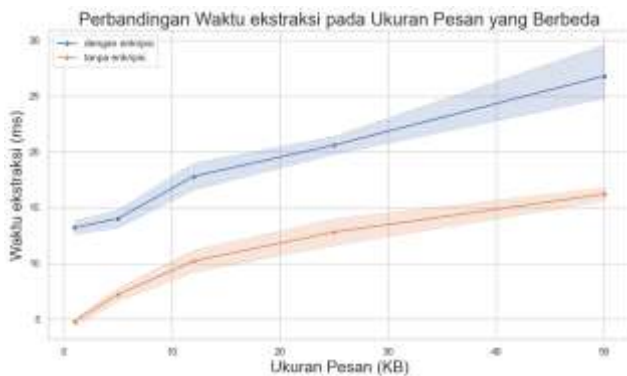
Gambar IV.13 Perbandingan waktu ekstraksi pada ukuran pesan yang berbeda
