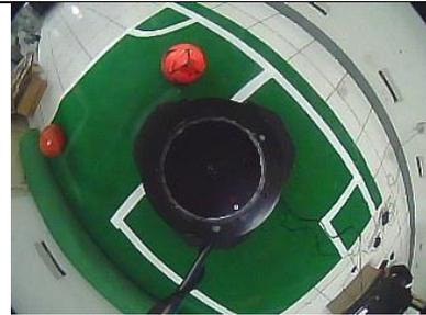
Gambar asli sebelum dilakukan pengolahan citra. Terlihat bahwa terdapat 2 bola berada di dalam lapangan dengan jarak berbeda terhadap titik pusat robot.
