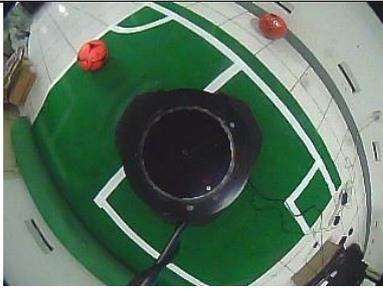
Gambar asli sebelum dilakukan pengolahan citra. Terlihat bahwa bola berada di dalam lapangan dan ada warna lain yang menyerupai warna bola yang lebih dekat terhadap robot.
