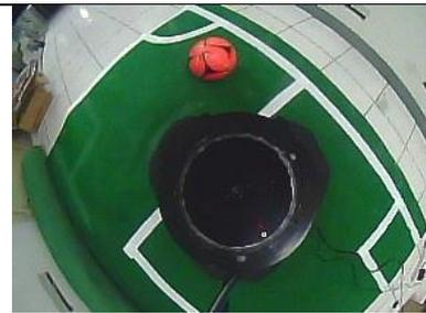
Gambar asli sebelum dilakukan pengolahan citra. Terlihat bahwa bola berada di dalam lapangan dan tidak ada warna lain yang menyerupai warna bola.
