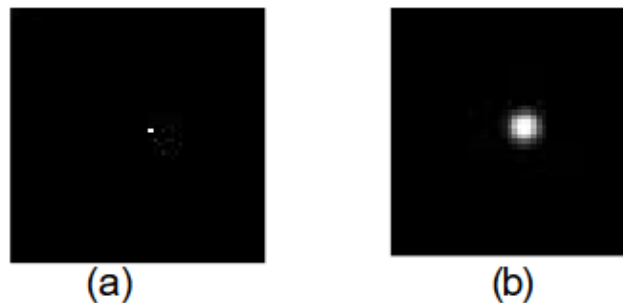
Gambar 1.1. Point Spread Spectrum pada citra bintang yang ditangkap oleh teleskop. Penjelasan gambar: (a) Citra bintang seharusnya, (b) citra bintang yang diamati akibat distorsi oleh PSF .
