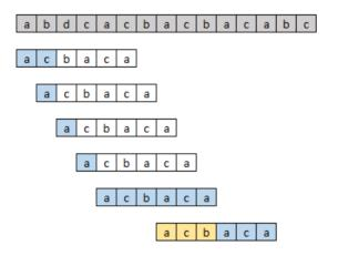
Gambar 2. Ilustrasi pencocokan string dengan algoritma Knuth-Morris-Pratt.
