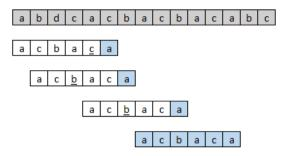
Gambar 3. Ilustrasi pecocokan string dengan algoritma Boyer-Moore.
